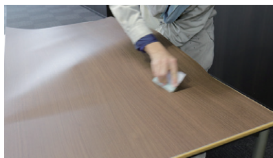
粘着剤付きのメラミン化粧板は、テーブルの天板だけを補修することができる
